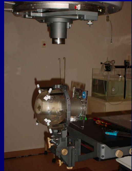
Fantomas antropomórfico del MDA Cancer Center, para verificación SRS
