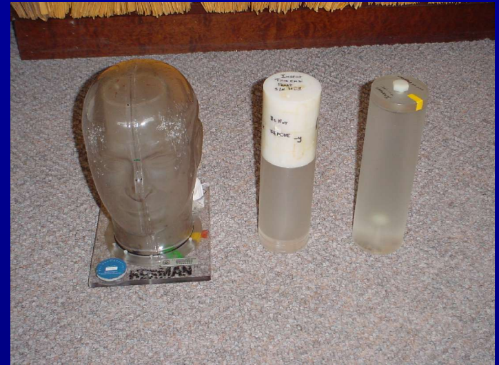
Fantomas antropomórfico del MDA Cancer Center, para verificación SRS
