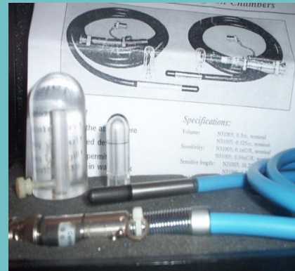
Cámara de Ionización PTW31003 Detector de diodos Mapcheck
