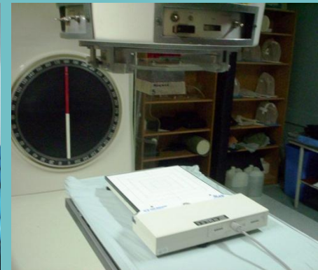
Cámara de Ionización PTW31003 Detector de diodos Mapcheck
